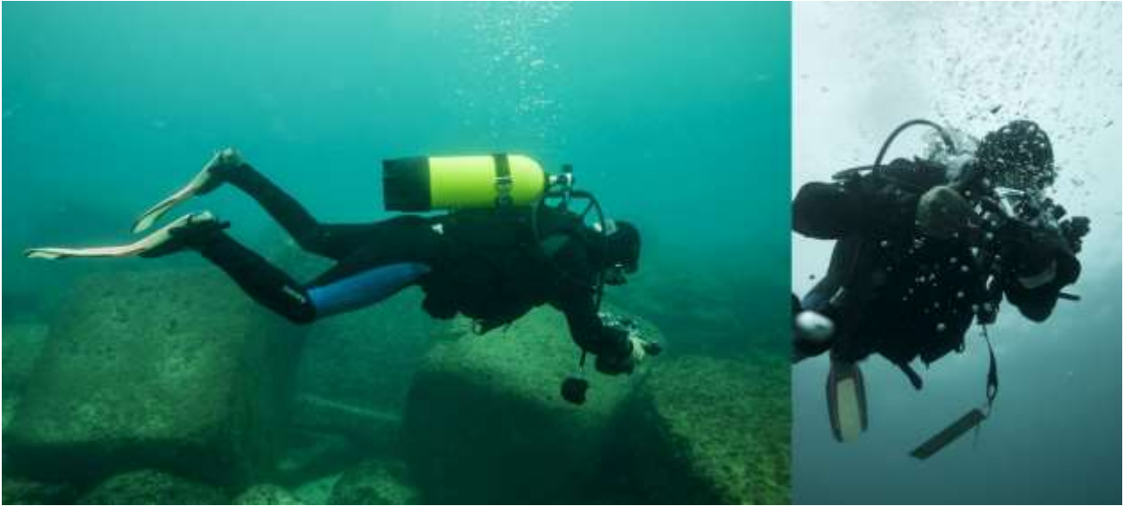
(شكل ١٠) د. محمد السيد اثناء تصوير الموقع مساحيا تحت الماء باستخدام كاميرا Nikon D700 والتقاط الصور بشكل مستمر ومتتابع باسقاط شبه عامودي (تصوير - فيليب سوبياس Philippe soubias مركز الدراسات السكندرية ٢٠١٦ م)
