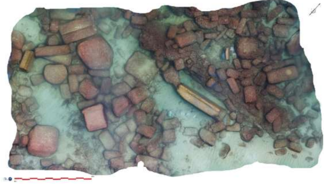
(شكل ١٣) أول صورة اورتوغرافية Ortho Photo تمثل جزء من اموقع المغمور لمساحة قدرها ٧٥٠م ٢ وقد استخدمت ١٣٢٢ صورة فوتوغرافية للحصول على نموذج ثلاثي الأبعاد . ( معالجة- محمد عبد العزيز ، تصوير د. محمد السيد ، ٢٠١٤م )
